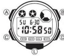
Послідовне натискання кнопки "C" забезпечує переход з режиму до режиму у наступній послідовності: Режим Поточного Часу – Режим Таймеру Відліку Часу – Режим Секундоміра – Режим Звукового Сигналу – Режим Часу міста іншого часового поясу – Режим Поточного часу.
